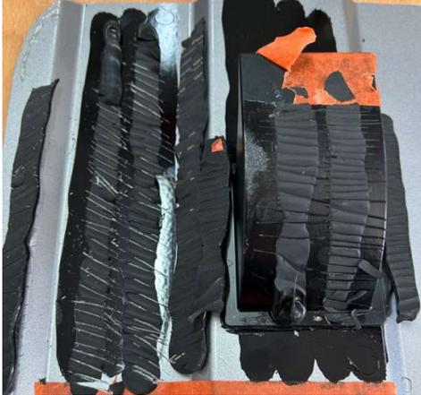
Die vorgeschriebene Oberflächenbehandlung führt zu einer optimalen Klebstoffhaftung auf beiden Werkstoffoberflächen.
